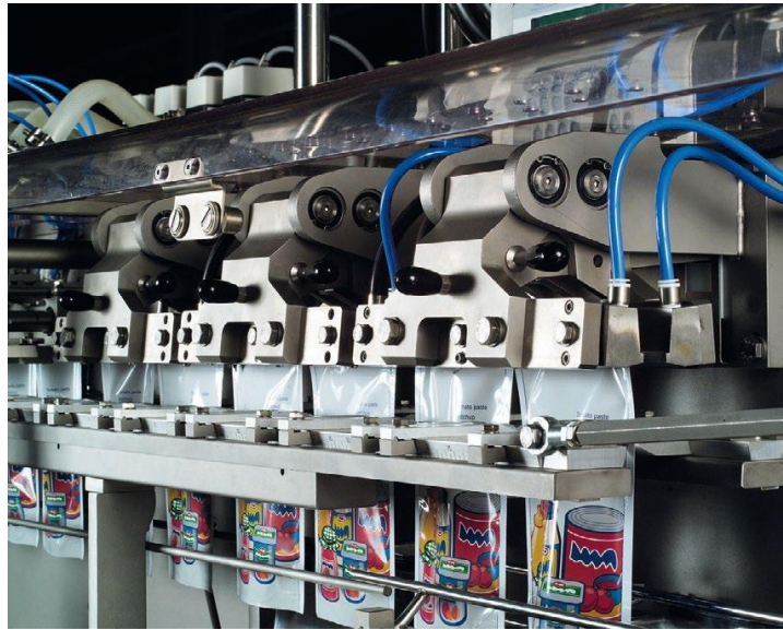
FIGURA 2. 3 MORDAZAS DE ENFRIAMIENTO- MÁQUINA ENVASADORA
