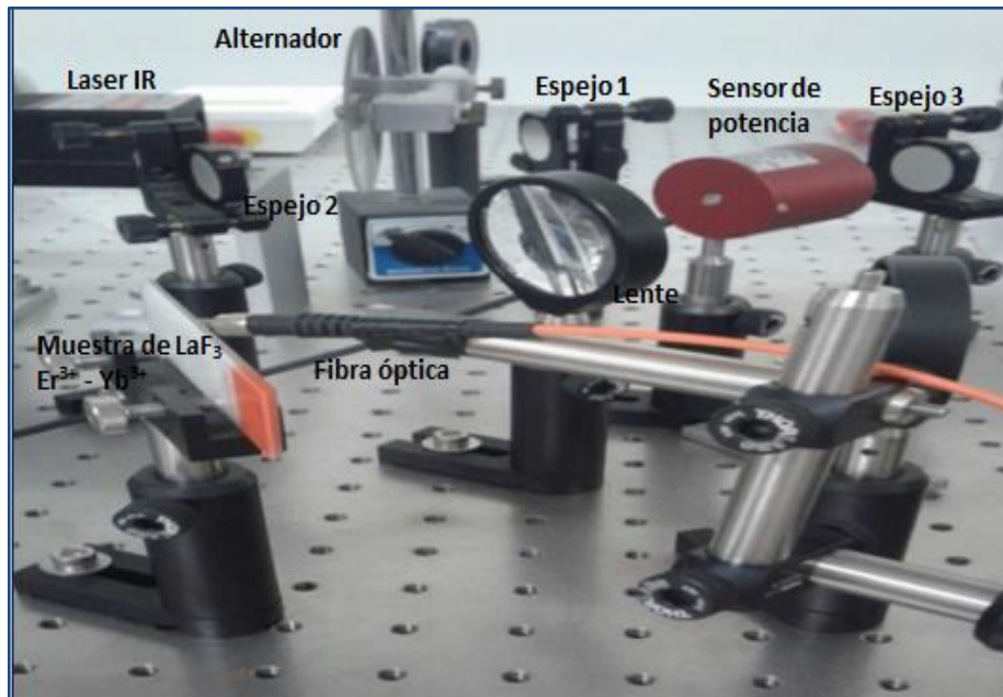
Figura 4.3. Imagen de los componentes ópticos utilizados para el registro de los espectros de emisión por “ upconversion ” del LaF 3 :Er 3+ - Yb 3+ .
