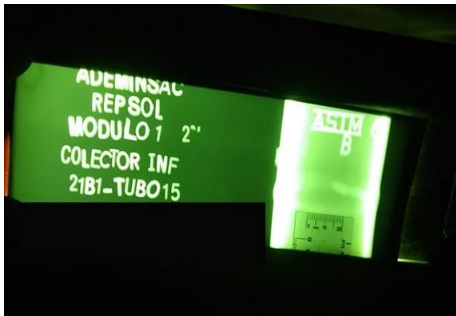
Figura 3.26: Poros agrupados en unión niple-tubo colector inferior del módulo N°1.
