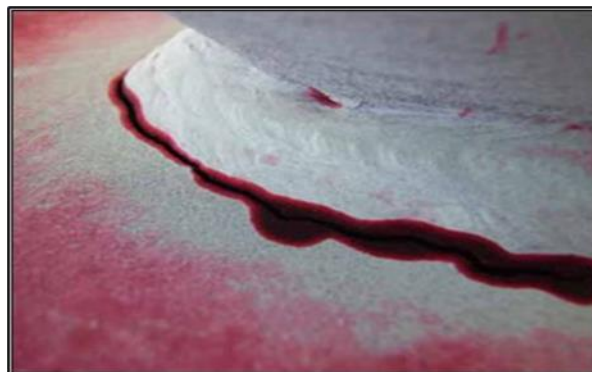
Figura 2.15: Inspección por tinte penetrante visible.
