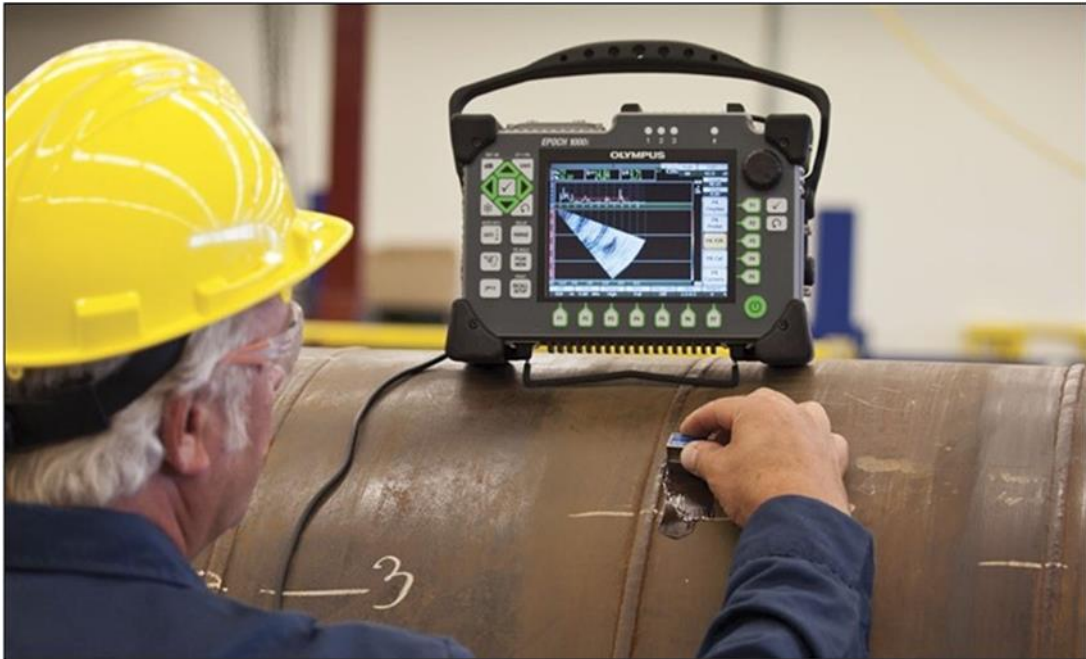
Figura 2.48: Inspección de soldadura mediante el método Phased Array.
