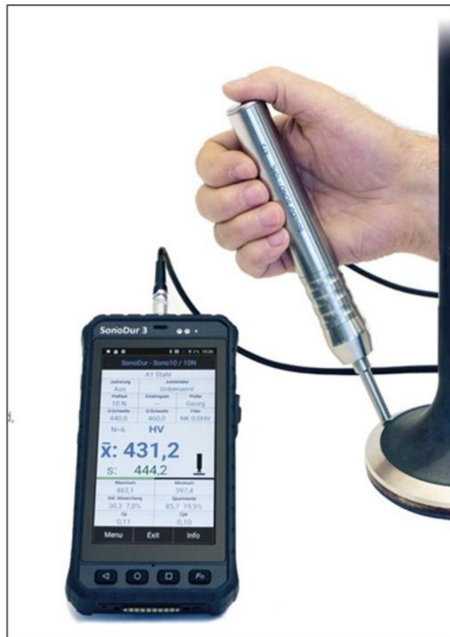
Figura 2.5: Medición de dureza con durómetro portátil SonoDur 3.
