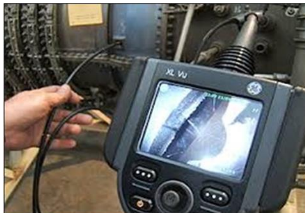
Figura 2.11: Inspección visual remota usando un boroscopio GE Inspections XL VU.
