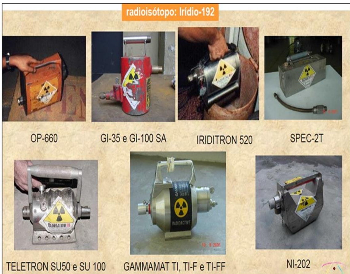
Figura 2.34: Modelos de irradiadores de Iridio-192.
