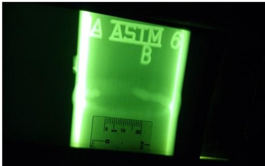
Figura 3.25: Poros agrupados en unión niple-tubo colector inferior del módulo N°2.
