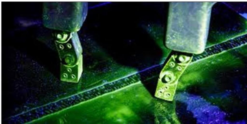
Figura 2.24: Inspección por partículas magnéticas fluorescentes.
