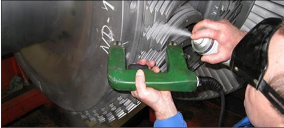
Figura 2.22: Inspección por partículas húmedas.
