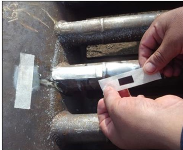
Figura 3.13: Aplicación de la película de acetato de celulosa.
