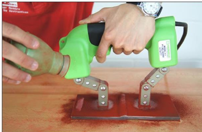
Figura 2.21: Inspección por partículas secas.
