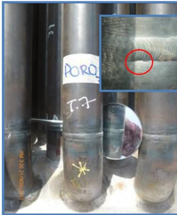
Figura 3.9: Poro en unión niple superior y tubo N°7 de la fila 3
