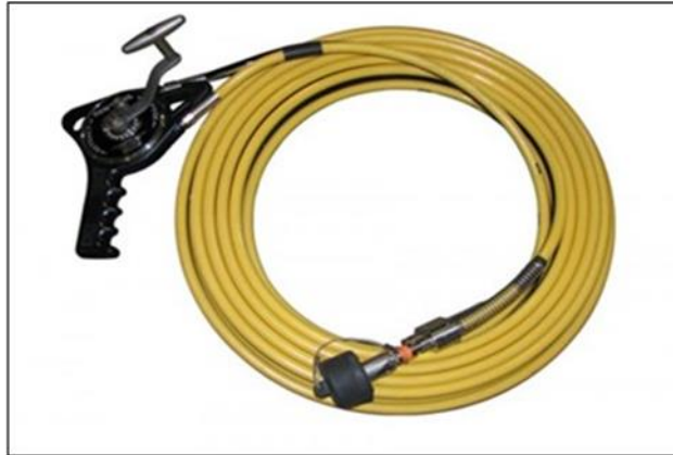
Figura 2.40: Telemando para gammagrafía industrial.
