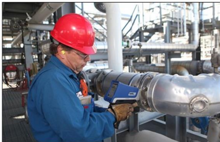
Figura 2.60: Identificación positiva de material (PMI) de brida.
