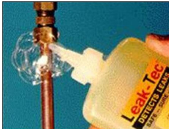
Figura 2.57: Detección de fugas por el método de burbujas.
