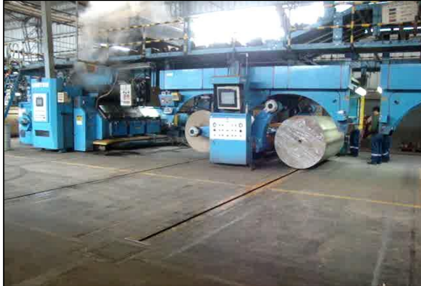
FIGURA N° 37 BOBINA DE PAPEL SOBRE EL CARRO TRANSPORTADOR LLEGANDO A SU POSICIÓN FINAL
