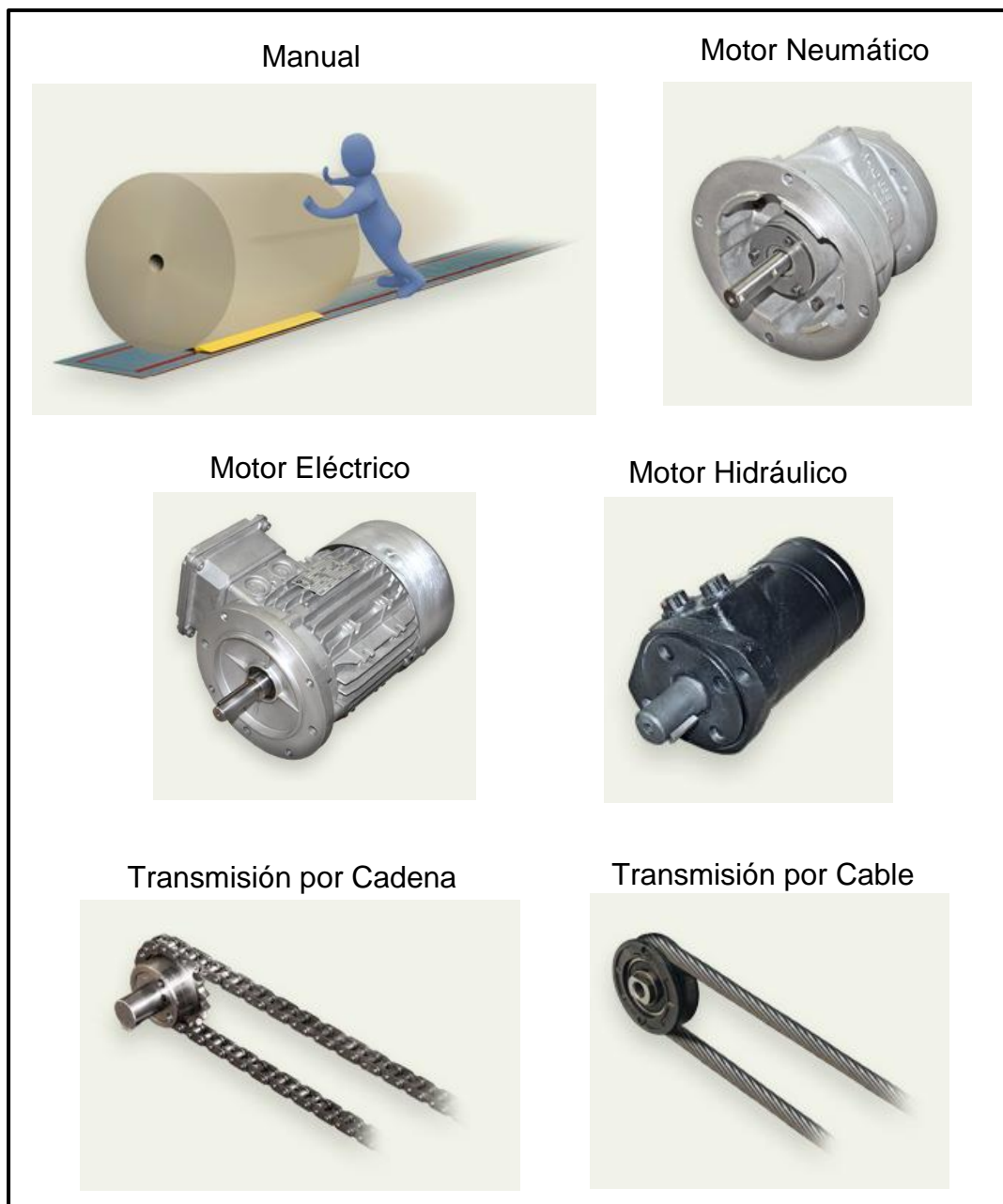
FIGURA N° 12 SISTEMAS DE ACCIONAMIENTOS DE TRANSPORTADOR DE BOBINAS DE PAPEL
