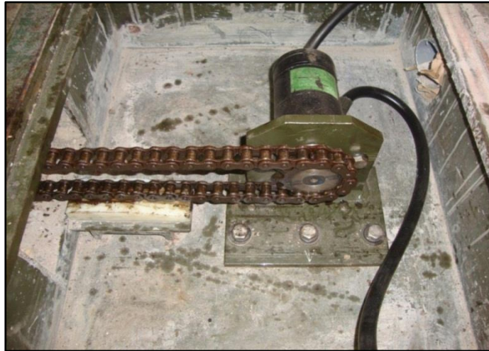
FIGURA N° 31 MOTOR HIDRÁULICO, PIÑÓN Y CADENA DE TRANSMISIÓN
