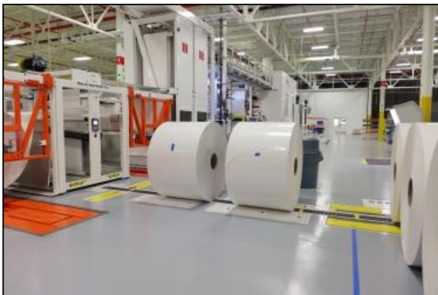
FIGURA N° 10 SISTEMA TRANSPORTADOR CONTINUO DE BOBINAS DE PAPEL
