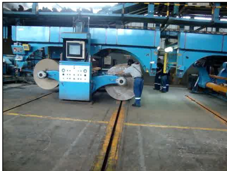
FIGURA N° 38 BOBINA DE PAPEL INSTALANDOSE EN LA MAQUINA CORRUGADORA
