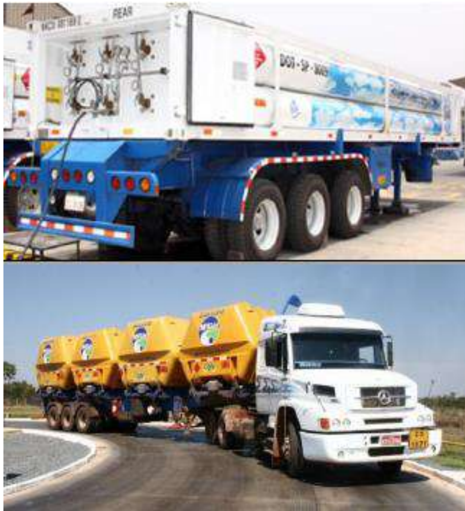
Figura 2.15: Modelos de unidades semirremolques utilizados para el transporte de GNC, del tipo cilindros (arriba), del tipo modular (abajo)
