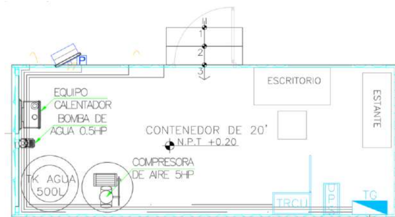
Figura 3.25: Sala de control de estación de descompresión GNC.
