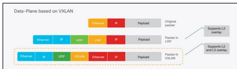
Figura 10 - Plano de datos del Fabric basado en VXLAN Fuente: CISCO Live! 2019.
