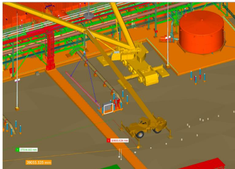
Figura 3.10 Montaje de tubería galvanizada
