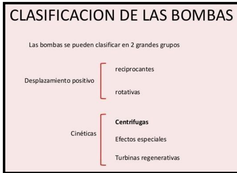
Figura N° 46 Utilización de bombas
