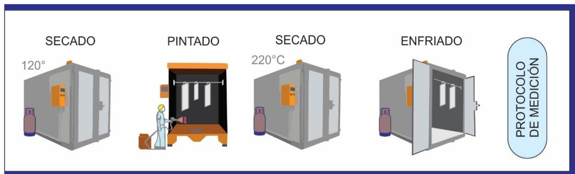
Figura N° 17 PROCESO DE PINTURA COMPONENTES DE LA ESTRUCTURA MECÁNICA
