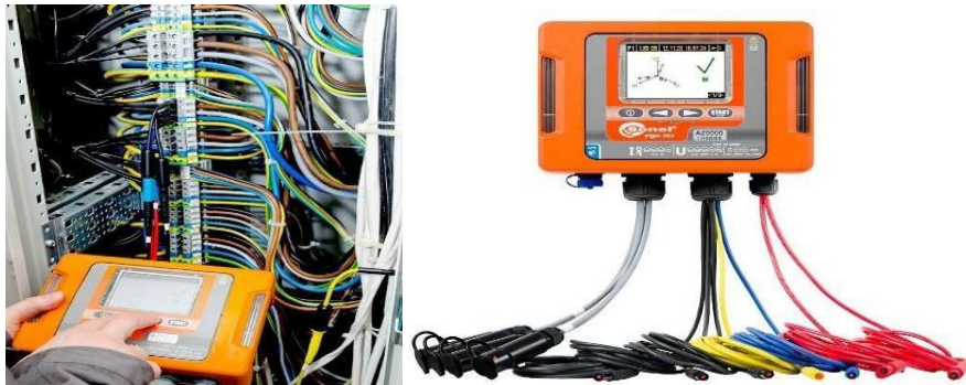
Figura 14. Analizador de calidad de energía PQM-703: Medición de Transitorios y Armónicos
