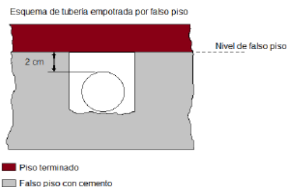
Figura 2. PROFUNDIDAD DE TUBERÍA EMPOTRADA.
