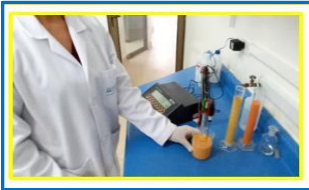
Figura 20. Medición del ph de bebida nutracéutica.
