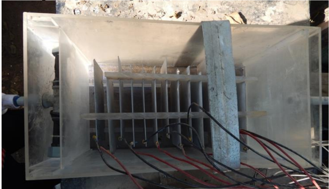
Celda Original del Electrocoagulador de la Primera Parte
