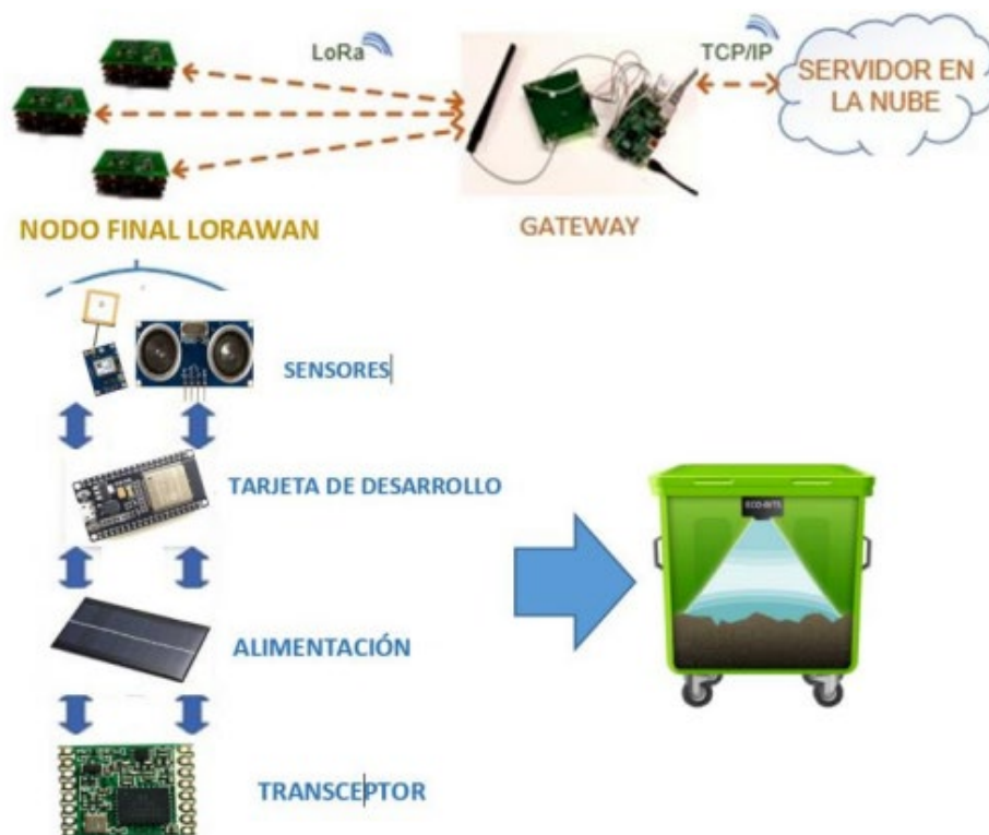
Figura 5. Esquema general del prototipo
