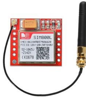
Figura 17. SIM 800L con antena de 3 dBi
