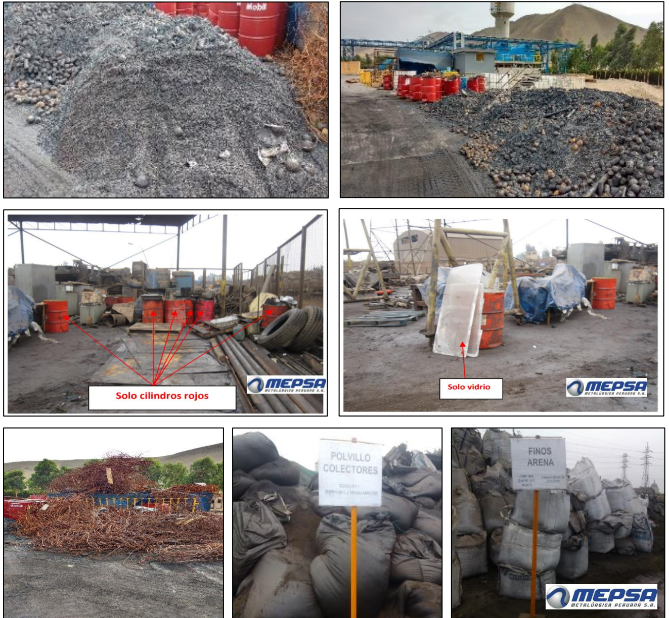
Figura 27. Fotografías del inadecuado uso y almacenamiento de los residuos sólidos (Cilindros de aceite residual, cascarilla o laminilla de Fe, alambres, vidrios, cartones, tubos de fierro, polvillo de colectores, finos arena, alambres, fierro entre otros).
