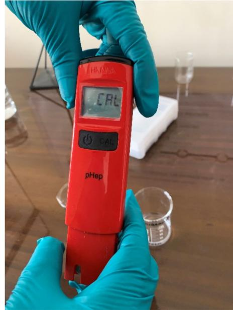
3. Potenciómetro indica usar (solución) pH = 4.01
