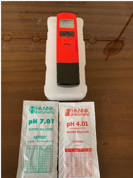
2. Potenciómetro modo Calibración, nos indicará el orden a calibrar.
