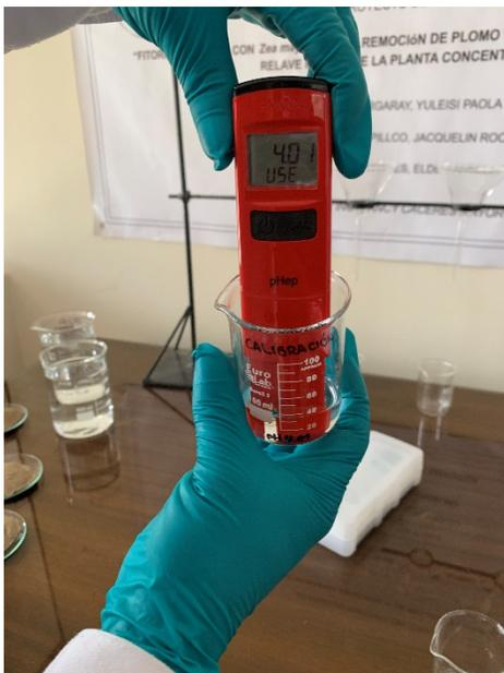
4. Potenciómetro indica usar (solución) pH = 7.01
