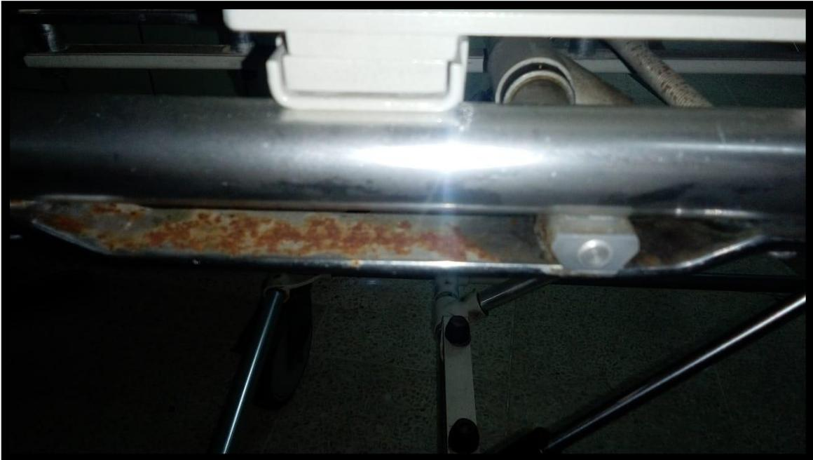
Figura 33. oxido en el sistema lateral de conversión del coche
