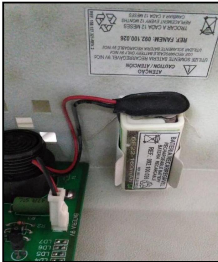
Figura 47. Batería de 9v encontrada en el equipo con conexión a la tarjeta principal
