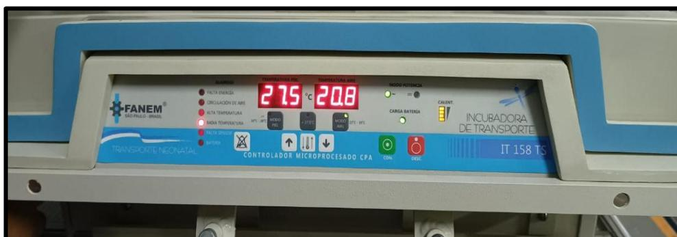
Figura 106 Incubadora se encontró descalibrada en el modo piel.
