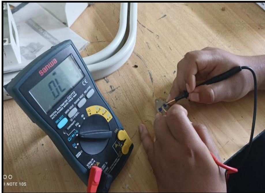
Figura 59. Medición de la base con emisor del transistor de alta potencia
