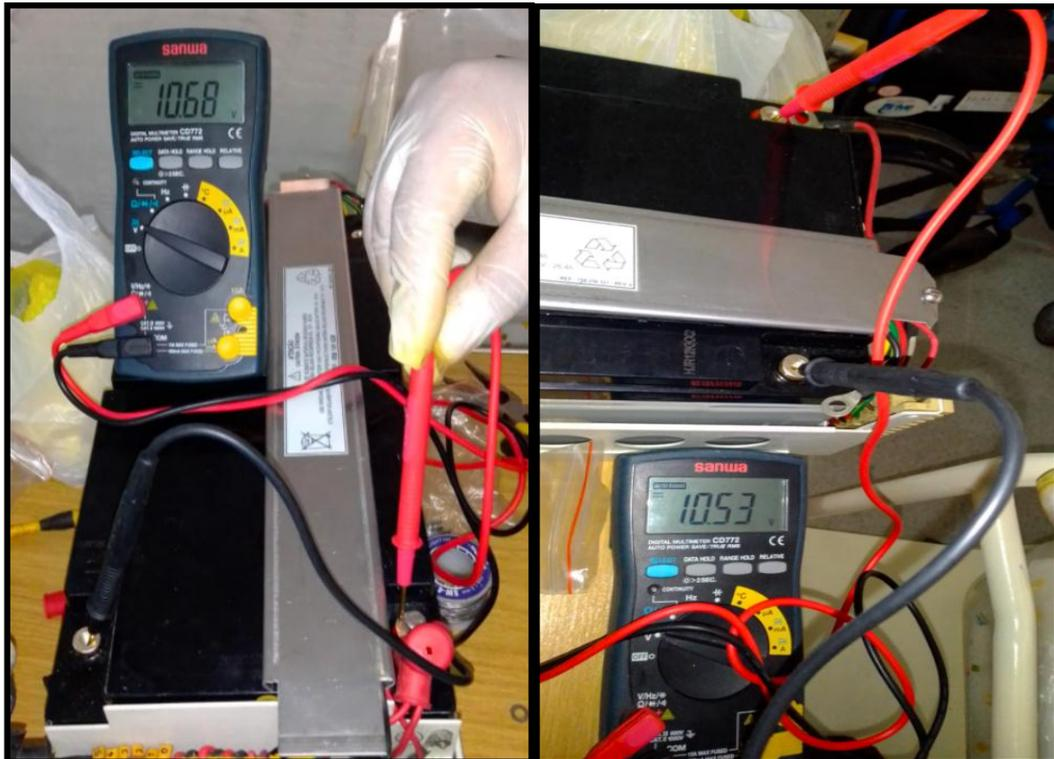
Figura 81. Validación de presencia de voltaje en las baterías nuevas. Muestra descarga por la falta de uso, pero en funcionamiento del equipo, vuelve a su estado normal
