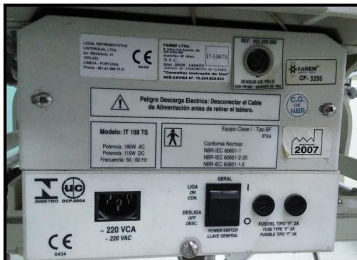
Figura 37. Panel de módulo de fuente o módulo de potencia
