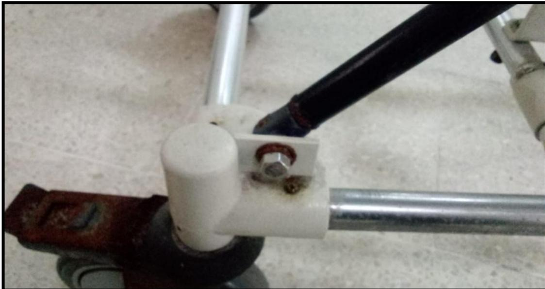
Figura 31. oxido en las 4 garruchas con ruedas del coche de transporte
