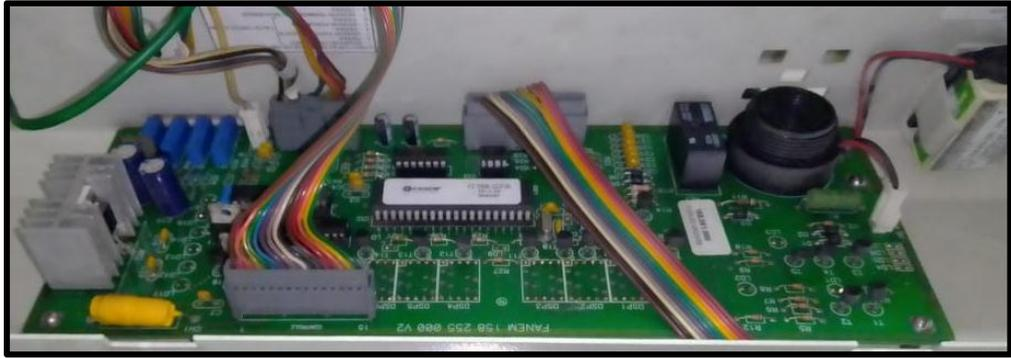
Figura 36. Estado de tarjeta mainboard o tarjeta principal
