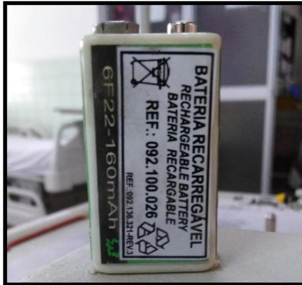
Figura 48. Batería de 9V
