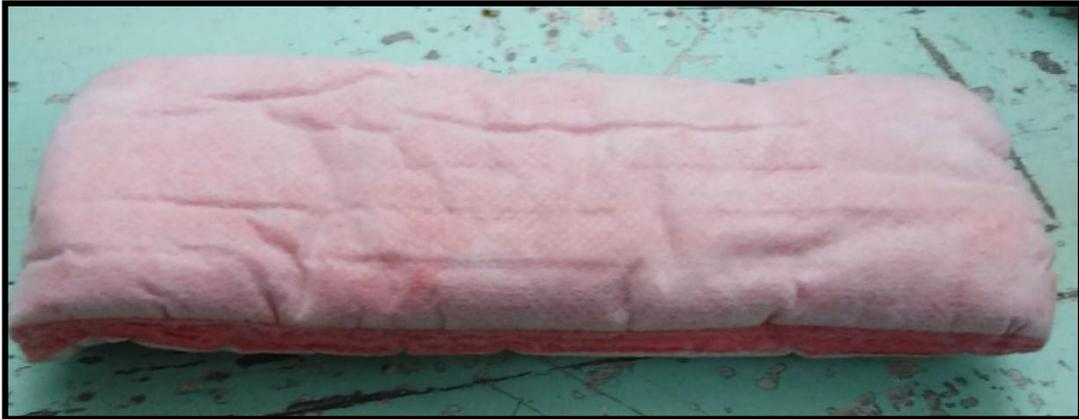
Figura 55. Estado del filtro de aire y el degrado que sufrió por el uso
