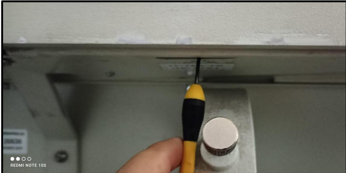
Figura 104 Ajuste de calibración del TP3
