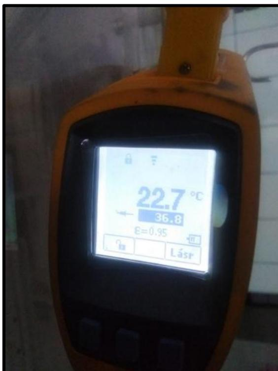
Figura 101. Calibración de temperatura modo aire, encontrando una variación de 0,8°C
