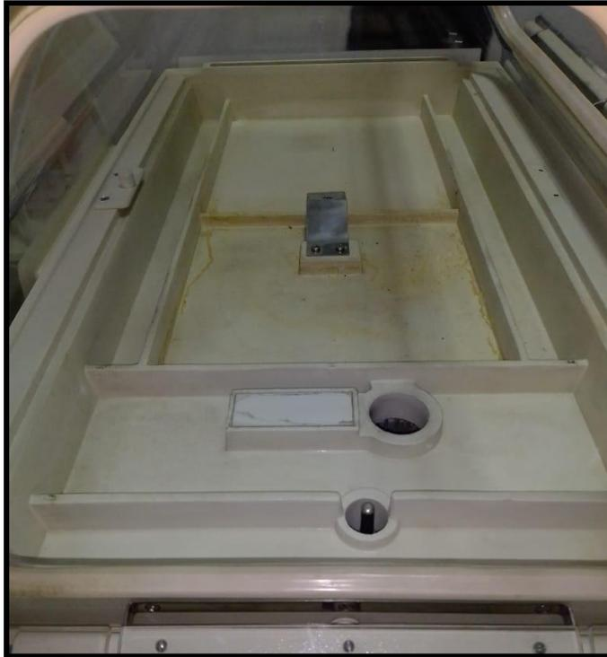
Figura 27. Suciedad en la base interna de la incubadora
