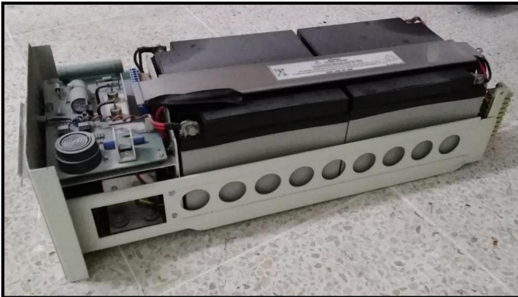
Figura 44. Módulo de carga completo encontrado en estado de suciedad
