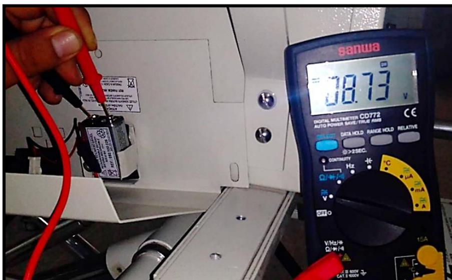
Figura 80. Prueba de medición de batería de 9V del panel de control
