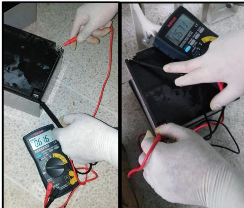
Figura 51. Verificación y medida de las baterías de 12 V
