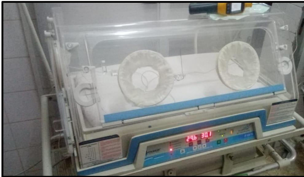
Figura 100. Calibración del modo aire con el termómetro digital
