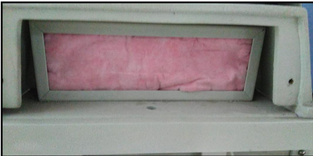
Figura 54. Estado del filtro de aire colocado en la incubadora
