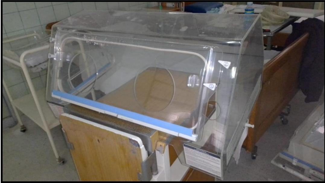
Figura 25. Suciedad en la cúpula externa
