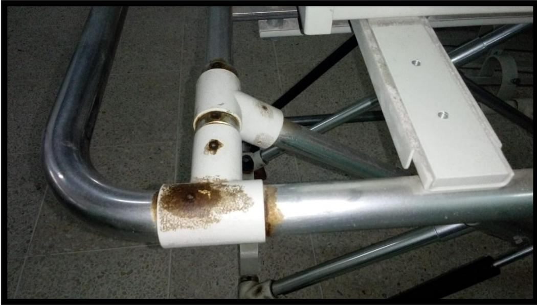
Figura 30. Suciedad y oxido en la parte superior del coche
