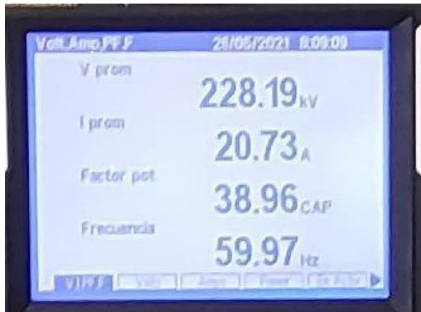
Figura 33 Lectura de un medidor ION 7650.
