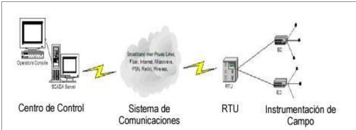
Figura 5 Elementos de un sistema SCADA
