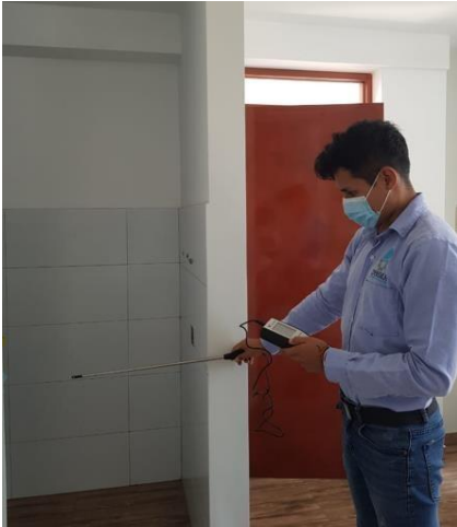
Foto 30: Medición de ventilación – Laboratorio
