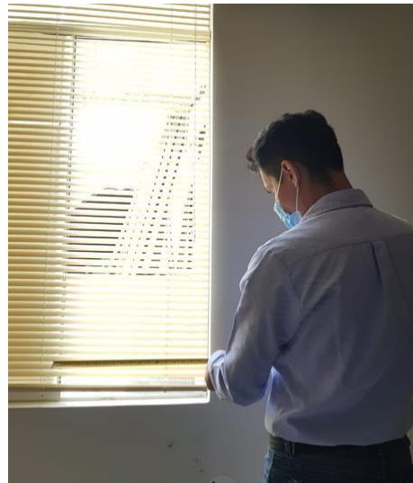
Foto 20: Medición de área de ingreso de aire – Oficina Saneamiento
