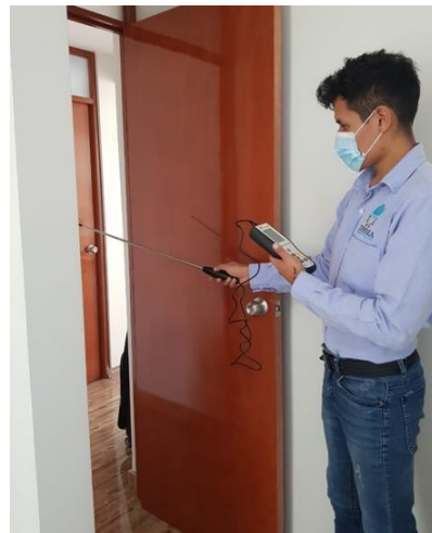
Foto 6: Medición de ventilación – Gerencia
