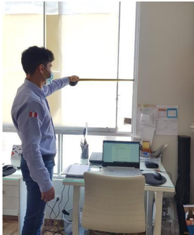
Foto 13: Medición de área de ingreso de aire – Oficina Ambiental
