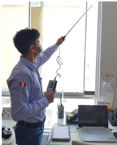
Foto 17: Medición de ventilación – Oficina Ambiental
