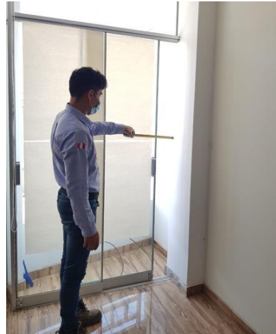
Foto 8: Medición de área de ingreso de aire – Oficina Ocupacional
