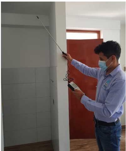
Foto 29: Medición de ventilación – Laboratorio
