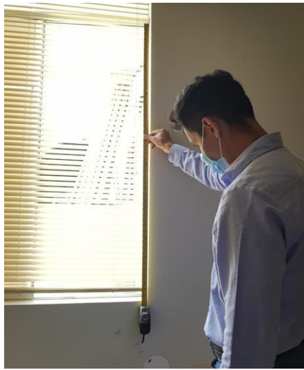
Foto 19: Medición de área de ingreso de aire – Oficina Saneamiento
