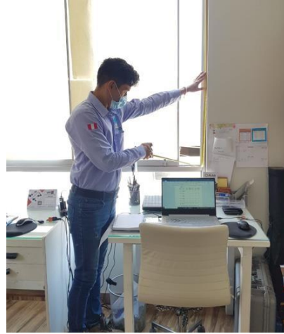
Foto 14: Medición de área de ingreso de aire – Oficina Ambiental
