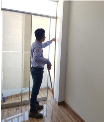
Foto 7: Medición de área de ingreso de aire – Oficina Ocupacional
