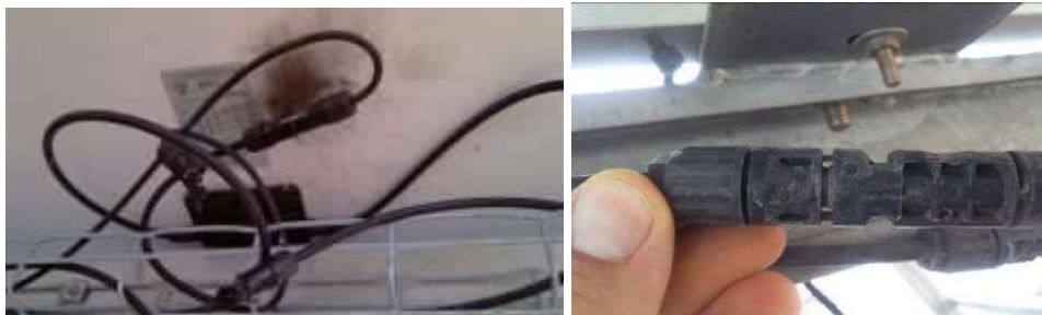
ILUSTRACIÓN 56 IZDA: CONECTORES QUEMADOS POR MALA CONEXIÓN (FUENTE: DGS BERLÍN E. V.); DCHA: CONECTOR NO DEBIDAMENTE CERRADO (FUENTE: PI BERLÍN AG)
