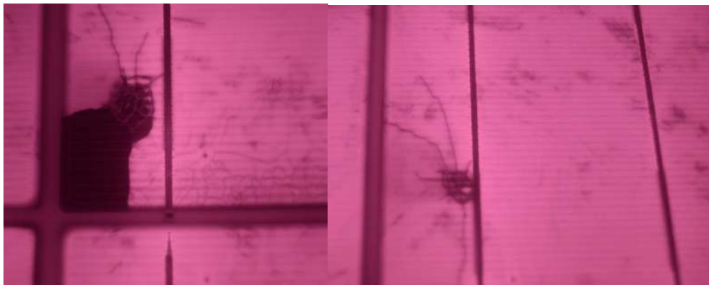
ILUSTRACIÓN 34 EJEMPLOS DE IMPACTO DE HERRAMIENTA SOBRE LA PARTE POSTERIOR DEL PANEL (FUENTE: PI BERLÍN AG)
