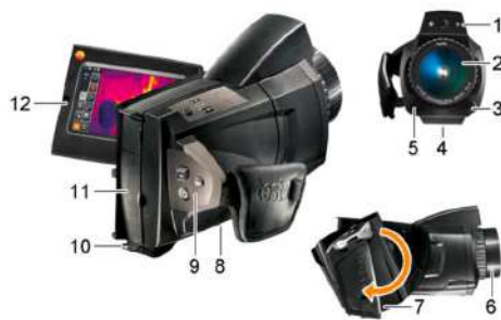
ILUSTRACIÓN 30 CÁMARA TERMOCRÁFICA (FUENTE: TESTO)
