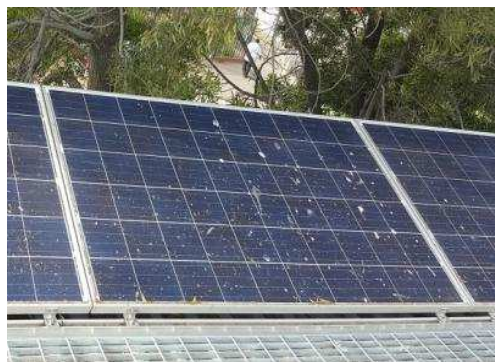
ILUSTRACIÓN 24 EJEMPLO DE MÓDULO FV CON ACUMULACIÓN DE EXCREMENTO DE ANIMALES. (FUENTE MINISTERIO ENERGÍA)
