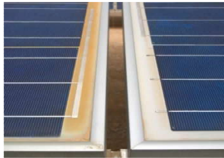
ILUSTRACIÓN 45 MÓDULO FOTOVOLTAICO AFECTADO POR DECOLORACIÓN, LO QUE CAUSA UNA BAJA REDUCCIÓN DEL RENDIMIENTO (FUENTE: PI BERLIN AG)
