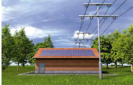
ILUSTRACIÓN 11 EN CASO DE EXISTIR LÍNEAS CERCANAS AL TECHO SE DEBE CUMPLIR CON LAS DISTANCIAS DE SEGURIDAD. (FUENTE: DGS BERLIN E. V.)
