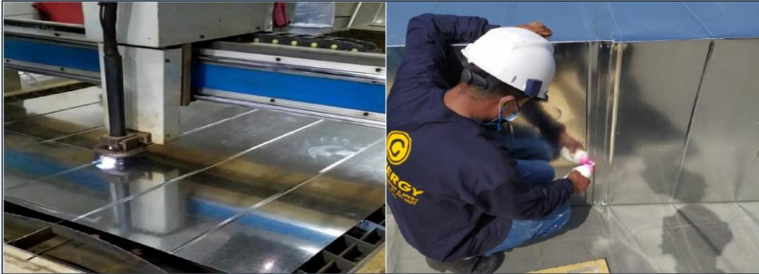
**Figura 29. Fotos de fabricación de ductos galvanizado**
