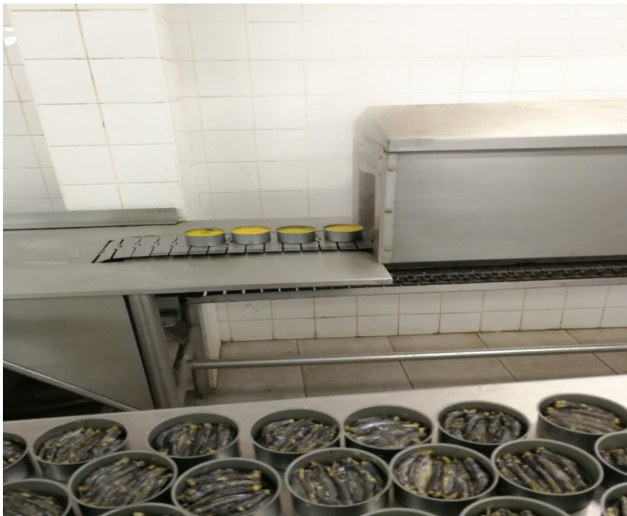
f. La anchoveta cocida junto con el líquido de gobierno terminando de pasar por el exhausting.
