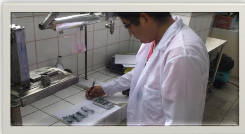
**Figura N° 18**, Peso de muestras de algas secas a determinados tiempos, Laboratorio de investigación e innovación
