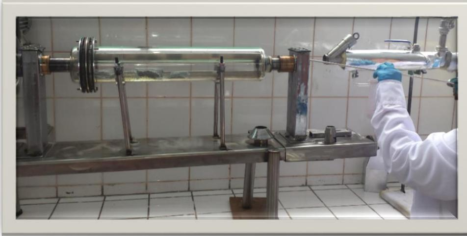
*Figura N° 14*, Ingreso de muestras de algas Nostoc en secador rotatorio discontinuo, Laboratorio de investigación e innovación
