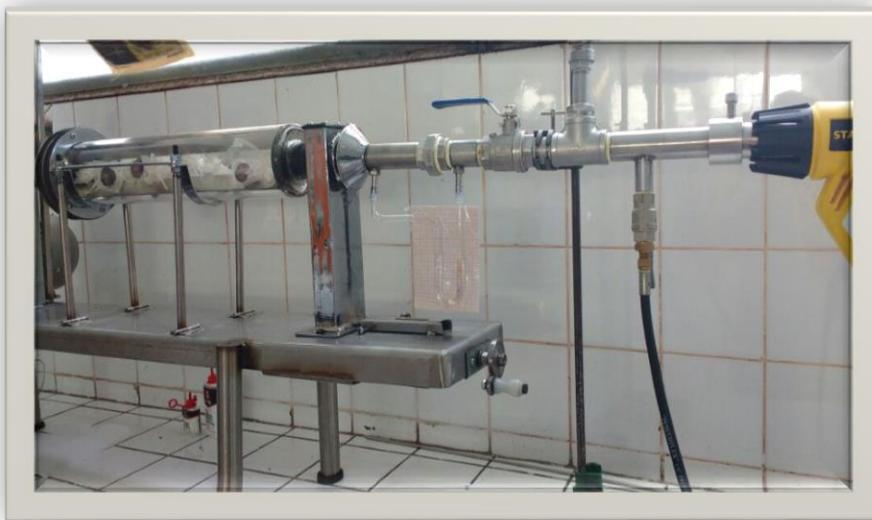
*Figura N° 15*, Secado de algas Nostoc en secador rotatorio discontinuo, Laboratorio de investigación e innovación
