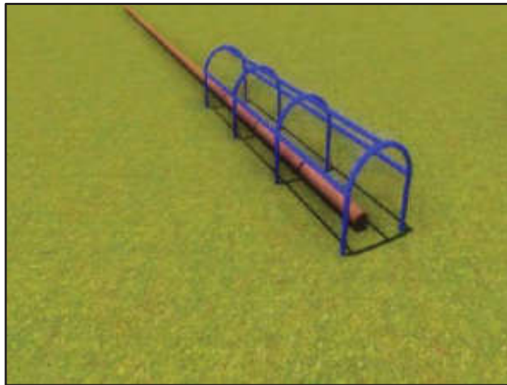
Imagen 1: Estructura de carpa de encapsulado
