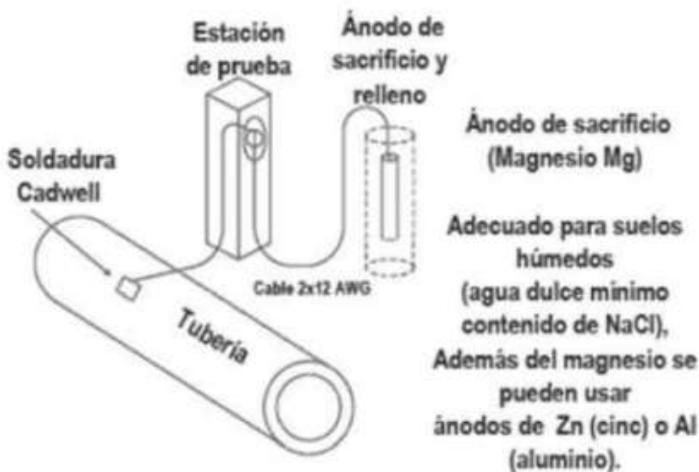
Figura 1. Sistema de conexión cátodo (tubería) - ánodo de sacrificio en condiciones de humedad del suelo
