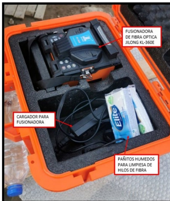
Fig. N.º 70: “Fusionadora JILONG KL-360E certificada para realizar trabajos en planta externa”
