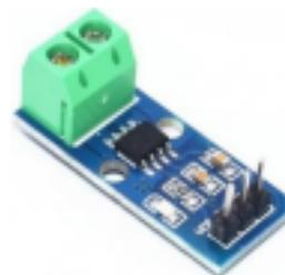
*Figura 5:Sensor de Corriente ACS712*
