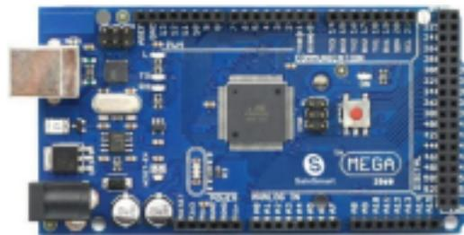
*Figura 4:Arduino Mega 2560*
