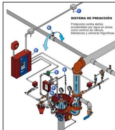
Figura 2.6 Tubería seca, Sistema de Pre-acción
