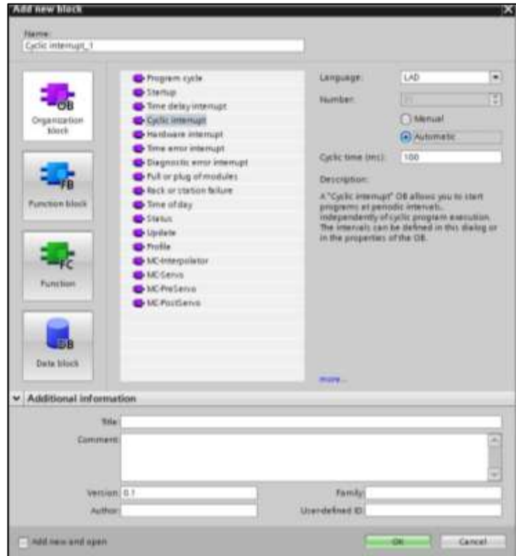
Figura N°21 "Bloque de interrupción del TIA Portal"
