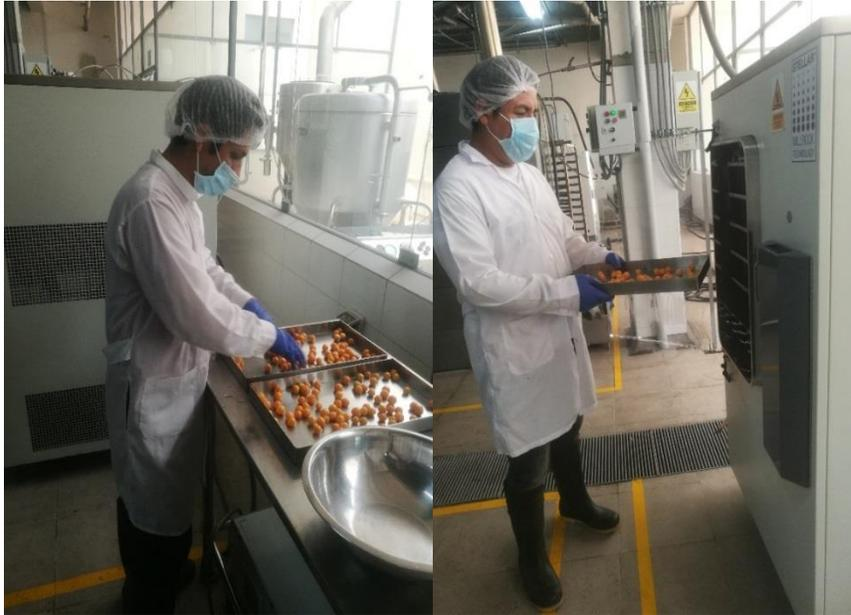
Llevamos las bandejas con el aguaymanto para iniciar el proceso de liofilizado
