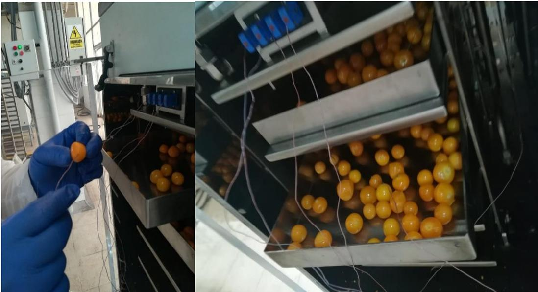
Acondicionar el aguaymanto en el liofilizador y colocamos sus sensores de temperatura
