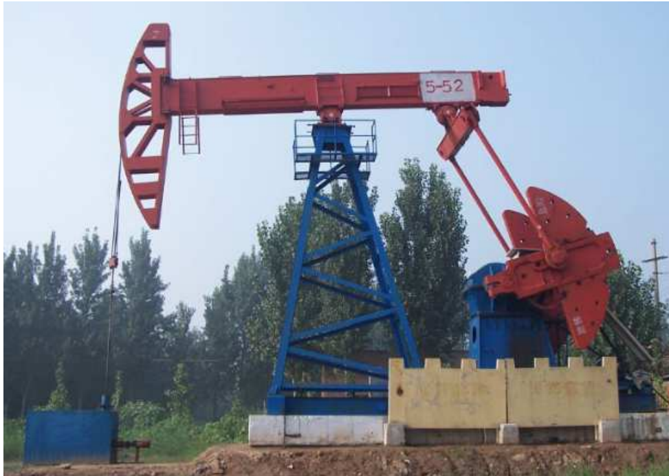
Figura 2: Bombeo por accionamiento mecánico.
