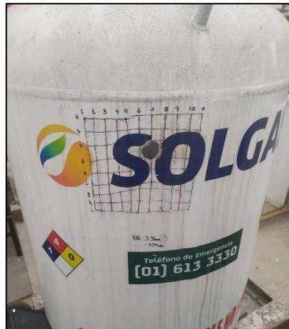
En el ejemplo mostrado podemos observar que se realizó la rejilla en una zona observada, se dividió de tal forma que se cubrió toda la zona afectada para su evaluación mediante el equipo medidor de espesores.
