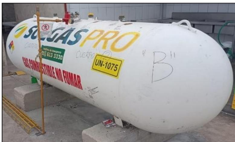
Como se puede apreciar en la imagen, el tanque fue codificado en los cuerpos con “cuerpo 1” y “cuerpo 2”. De igual forma la copla fue identificada como “C1” y el cabezal como “B”.
