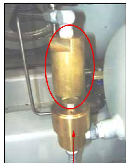
Válvula de bloqueo neumática (Sin filtro de partículas)
