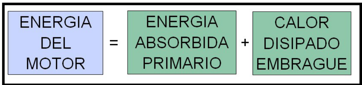
FIGURA 2.49 TRANSFORMACIÓN DE ENERGÍA DEL MOTOR
