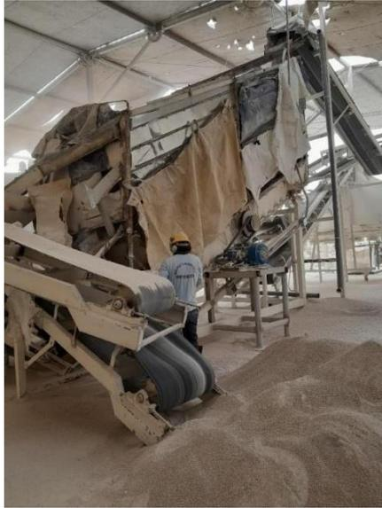
Esta zaranda recibe alimentación de 5 ton/hora actualmente, y consta de 7 salidas (o rechazos), para que el material sea trasladado posteriormente mediante fajas hacia silos pequeños, donde finalmente se ejecuta la descarga hacia bolsas bigbag, donde el material reposa y es posteriormente enviado al cliente final.
