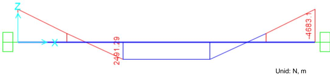
De las *Figuras 4.21 y 4.22*, notamos que la fuerza cortante máxima,  $V_{max} = 12382.17 \text{ N}$ , en los extremos empotrados, y el momento flector máximo  $M_{max} = 4683.1 \text{ N} \cdot \text{m}$ , respectivamente; también en los extremos empotrados.
