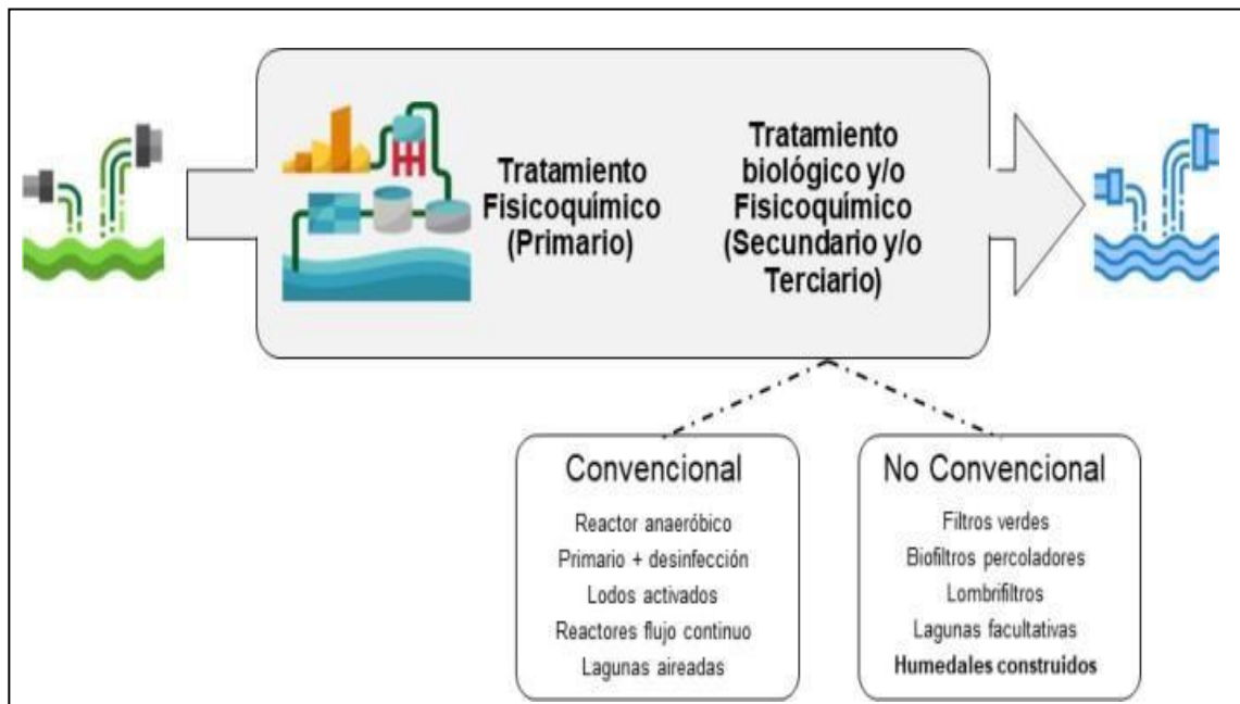
Figura 2: Tecnologías convencionales y no convencionales. Tomado de “Evaluación técnica y ambiental de la eliminación de fósforo en humedales construidos para el tratamiento de aguas residuales” por Carrillo, 2022.
