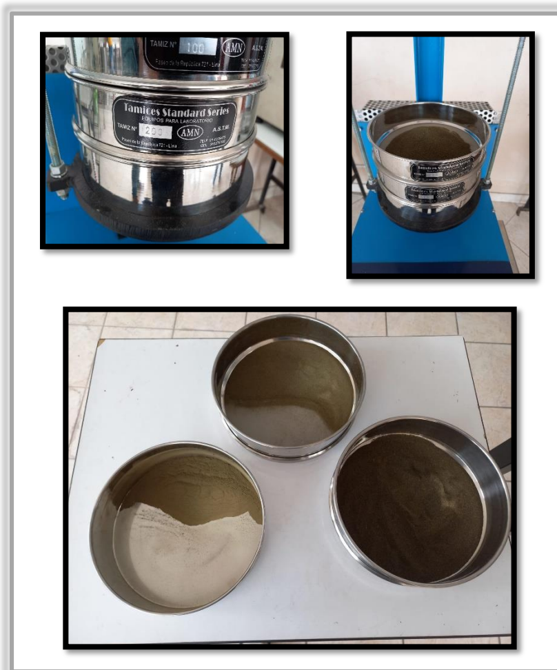
Fig.21. Tamizado y clasificado de la harina de cushuro Elaboración propia. 2023
