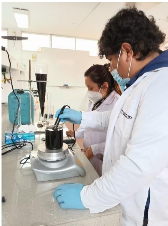
Fotografía 8. Mediciones de parámetros para su caracterización inicial y ajuste del pH inicial (2.5 – 3.0).
