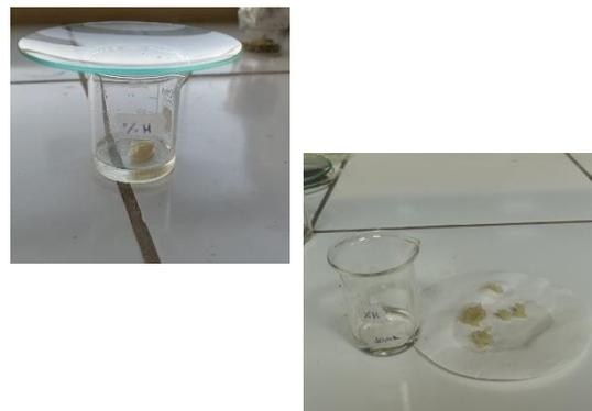
**Figura N° 19** Hidratación de polímero ulvano con 10ml de agua destilada y obtención de hidrogel natural.
