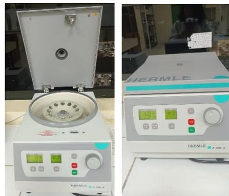
**Figura N° 13** Centrifugación de la mezcla a 30min. 2500rpm.
