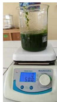
**Figura N° 9** Calentamiento de la mezcla a 50°C, 2h
