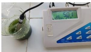
**Figura N° 8** Acidificación con 1ml de HCl a 1M, llevando la mezcla a pH=5
