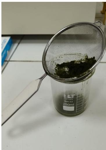
**Figura N° 12** 1era Filtración de la mezcla con malla gruesa N° 8
