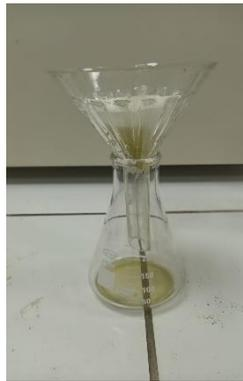
**Figura N° 14** 2da filtración del extracto obtenido con papel Whatman N° 40.
