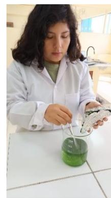
**Figura N° 7** Mezclado de algas secas con 125ml de agua destilada.
