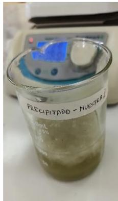
**Figura N° 16** Precipitado 1 día a T° Ambiente y formación del polímero ulvano.
