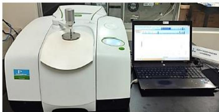
**FIGURA N°2.** Espectrofotómetro Infrarrojo de Transformadas de Fourier - Reflectancia total atenuada (FTIR-ATR). PERKIN ELMER, FRONTIER.
