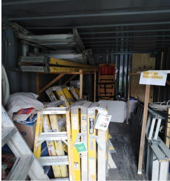
Figura N° 4: Deficiente organización de las escaleras
