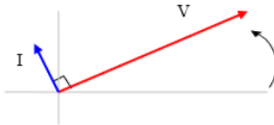
Figura 7. Diagrama fasorial de un circuito capacitivo
