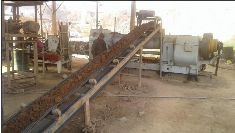
Fotografía 1. Faja transportadora sin pavimentar
