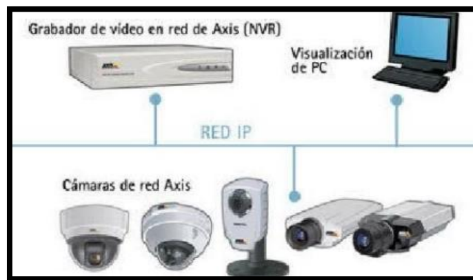
Figura N° 20. Sistema de vigilancia en red utilizando NVR
