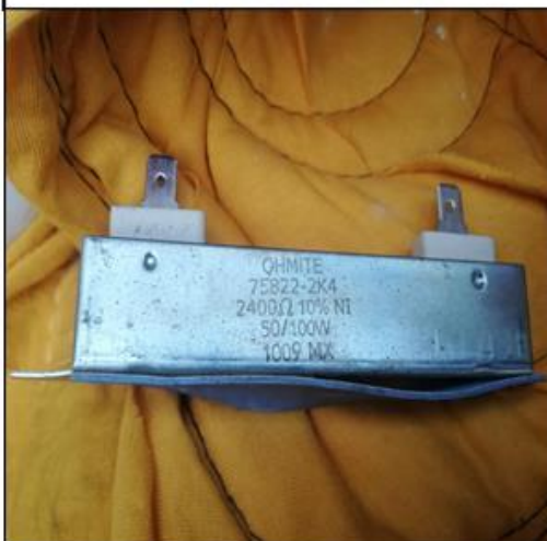
RESISTENCIA DE DE 2400 OHMIOS ESTA ABIERTA (INOPERATIVA)
