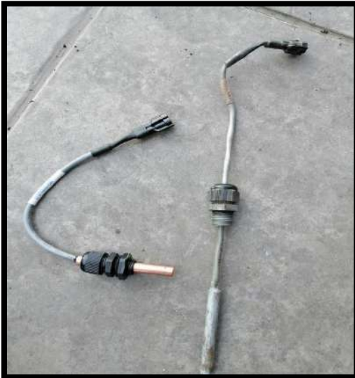
SENSOR AVERIADO Y SENSOR A INSTALAR
