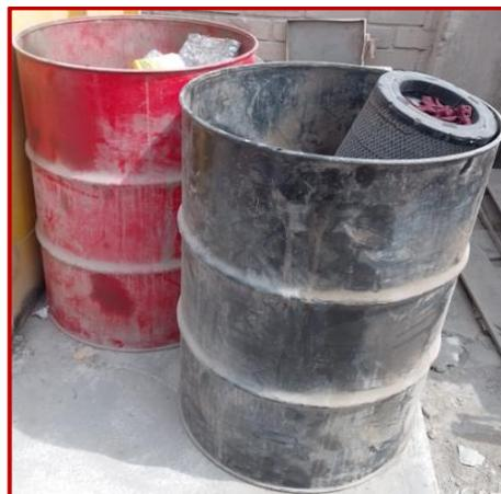
*Figura 17.* Uso de cilindros para determinación de volumen de residuos sólidos
