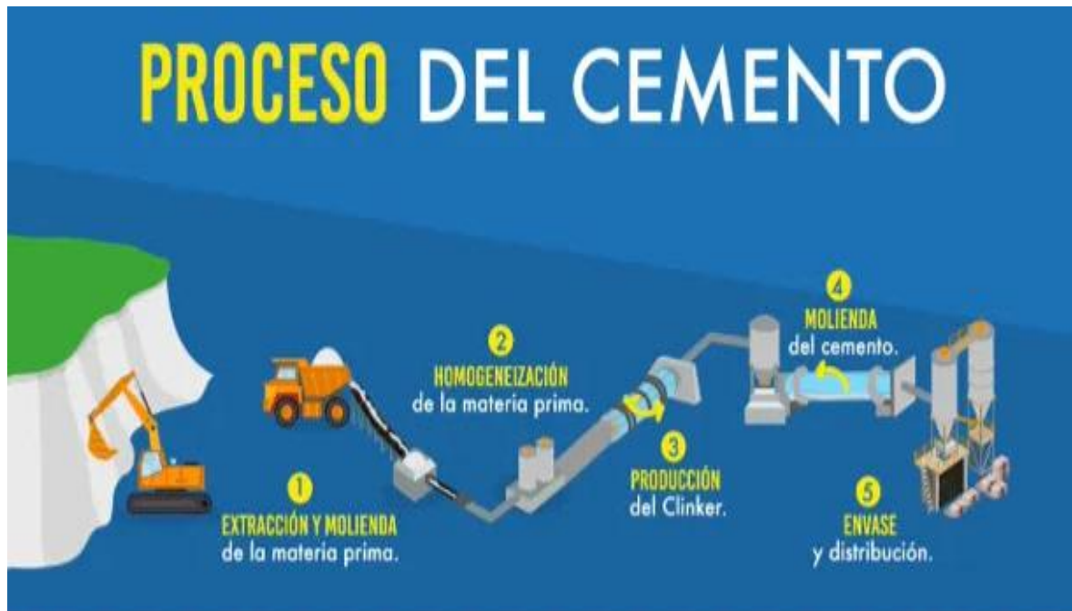
Fig. 2: Proceso de producción del cemento.
