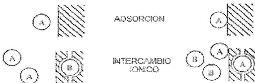
**Figura d.1.** Representación esquemática de los procesos de adsorción e intercambio iónico. [Adaptada de AGOUBORDE, L., 2008].
