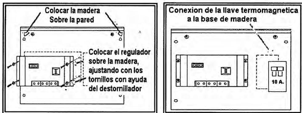
FIGURA 24: CONEXIÓN DE LA LLAVE TÉRMICA
