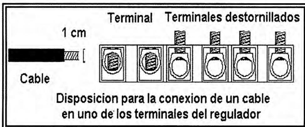
FIGURA 25: CONEXIÓN DE LOS TERMINALES DEL REGULADOR
