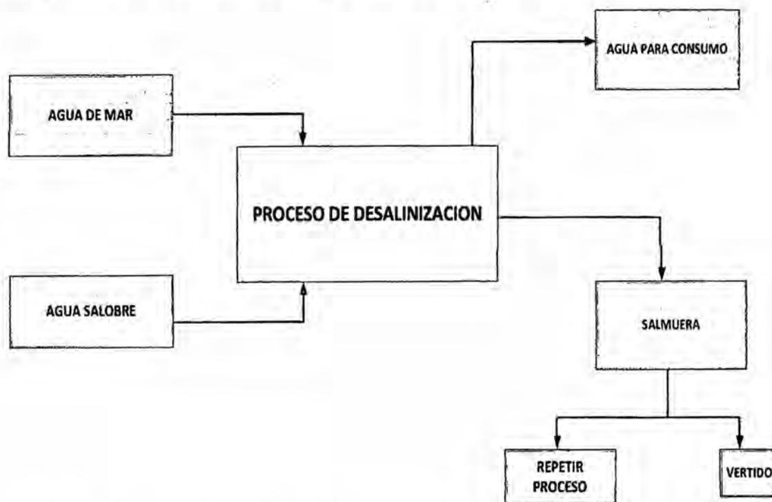
**Fig. 3.5. Diagrama de bloques del proceso de desalinización**
