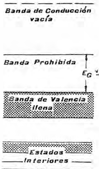
Figura 15: Bandas de energía de un aislador
