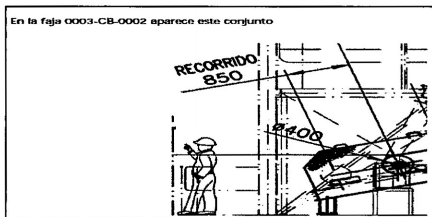
FIGURA N° 51: CONJUNTO DE TENSADO CON HUSILLO
